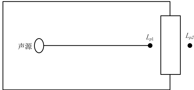
图 5.2-8 室内声源等效为室外声源图例
